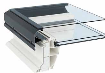
Das VELUX Flachdach-Fenster GLAS-KUPPEL erreicht durch die im Basiselement integrierte 2-fach-Verglasung einen sehr guten Wärmedämmwert von 0,75 W/(m²K).
