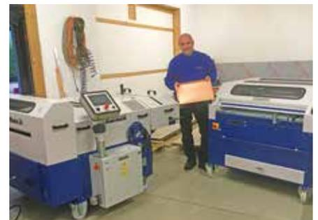
Firma Schwarting aus Wildeshausen setzt auf Eigeninitiative, wenn es um Profilierung und Abkantung geht. DENW lieferte dazu die passende SPA-Rollenschere inkl. Langstrennung und die elektrohydraulische Ausklinkeinheit EHA 3 vom Hersteller Schlebach.
