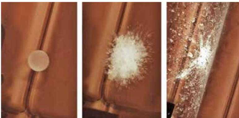
■ Die Kamera im Testaufbau dokumentiert die Hagelsicherheit des E 58 PLUS®. Er ist einer der robustesten Ziegel bei Hagel.
