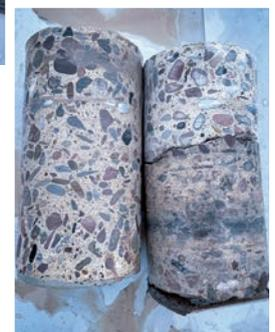
*Zwei Bohrkern aus Stahlbeton*
