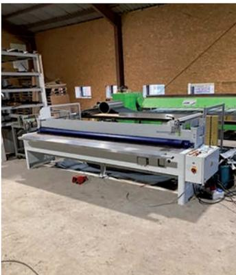
Wie Zweigstellenleiter Werner Lüttel berichtet, konnte dort kürzlich eine nagelneue Motortafelschere MHSU 3200/1,5mm des Herstellers Schröder aufgestellt werden.
