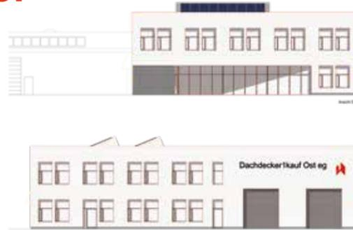
Im Anbau befindet sich noch eine zusätzliche Lagerhalle in konventioneller Bauweise. Generell entspricht das ressourcenschonend in hybrider Holzbauweise errichtete Gebäude höchsten Energiestandards. Geplanter Baubeginn ist 2025.
