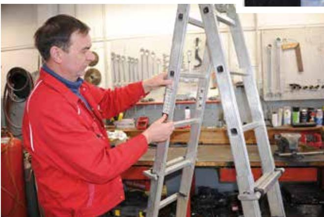
Das bedeutet allerdings nicht, dass die Sprossenleiter für Arbeiten grundsätzlich ungeeignet ist. Sie kann mit einzelnen Aufsteck-Stufen so aufgerüstet werden, dass eine Nutzung für hochgelegene Arbeiten zulässig ist. „Das machen wir bei uns regelmäßig für die Betriebe, weil die Aufrüstung oft günstiger ist als die Anschaffung einer neuen Stufenleiter“, berichtet Dirk Bansemir aus der täglichen Praxis.
