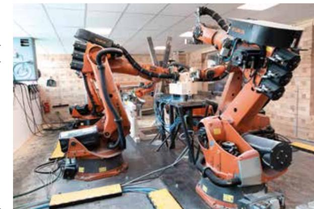
Die einzelnen Holzbausteine werden von Robotern gefertigt,
